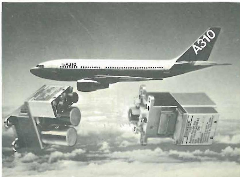
«Position Pick-off Unit» (PPU) per il nuovo Airbus A 310: i sincro di precisione realizzati dalla Siemens per conto della Società Liebherr Aero Technik GmbH, controllano la posizione delle alette e dei flaps in modo che la portata si distribuisca uniformemente sulle due superfici alari. Ogni PPU dispone di due sincro (a sinistra nella foto, senza calotta), montati in coppia su una custodia con rotismo ad ingranaggi.
