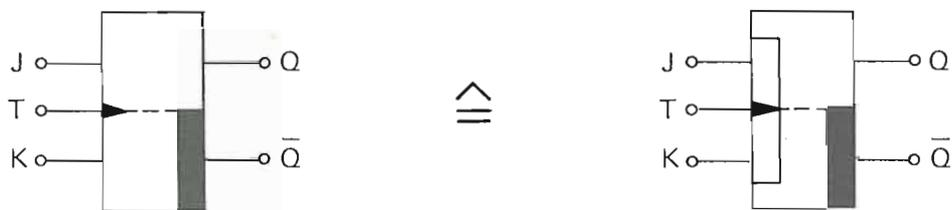
Fig. 8/8 - Rappresentazioni simboliche per il flip-floppmaster-slave-J-K (l'informazione viene trasferita all'uscita con i fronti di discesa).
